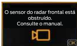
Aviso de bloqueio do sensor do radar
