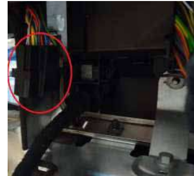
Conector elétrico de upfit da cabina
