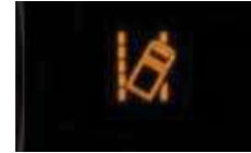
Luz de aviso do sistema de aviso de saída de faixa de rodagem
