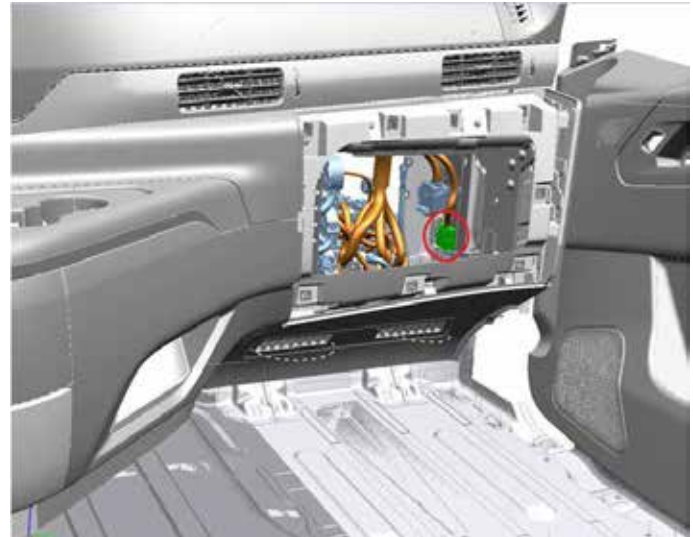
A localização do conector de Upfit localizado no compartimento da caixa de fusíveis
