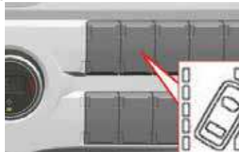
Botão de ligar/desligar do sistema de aviso de saída de faixa de rodagem
